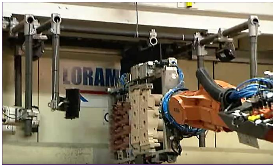
Fig. 4: Robô posicionando machos de cilindros e camisa d'água para controle dimensional com equipamento de visão 3D [4]
