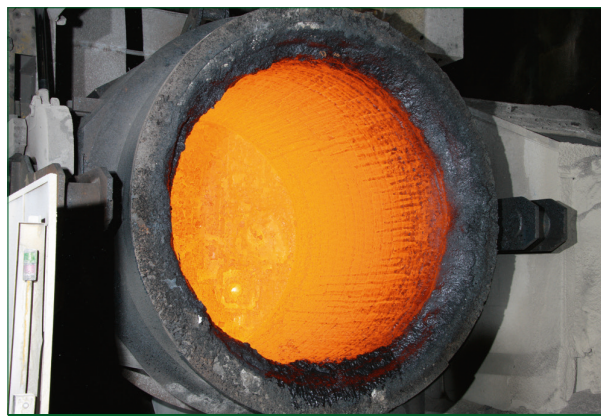
A tecnologia IBOS é um sistema inteligente de blocos pré-moldados, que substitui os fundos de panelas, aumentando a eficiência nos processos siderúrgicos. Crédito: RHI Magnesita/ Divulgação.
