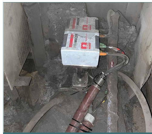
Sensor IR McON, para monitoramento dos gases de exaustão (Foto: Promecon)
